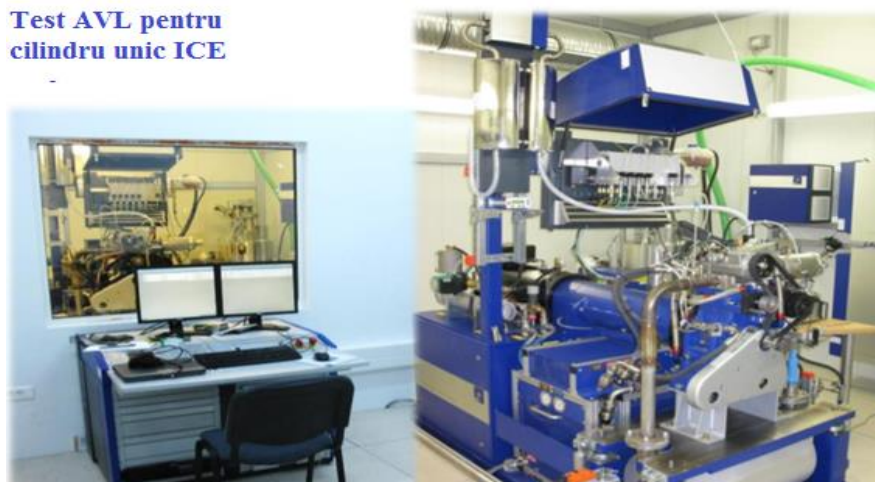
Figura 3.2 - Stand AVL pentru încercarea motoarelor monocilindrice
