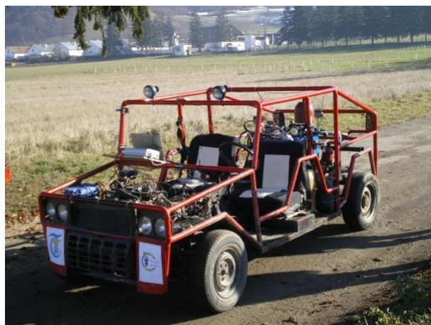
Figura 2.2 Concept-car cu propulsie hibrid-hidraulică și recuperare a energiei disipată în amortizoare realizat în Catedră
