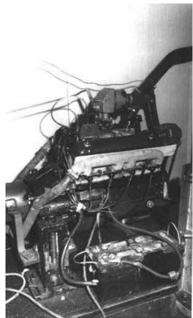
Instalație gazogen pentru obținerea de combustibil neconvențional
