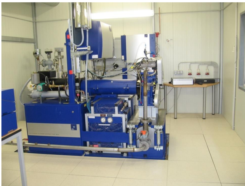
Figura 2.3 Standul Horiba din Laboratorul de Motoare al Catedrei
