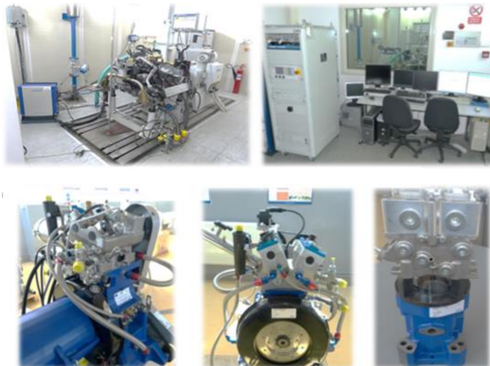
Figura 3.1 - Stand Horiba Titan 250 pentru încercarea motoarelor policilindrice; Stand AVL cu cilindru transparent
