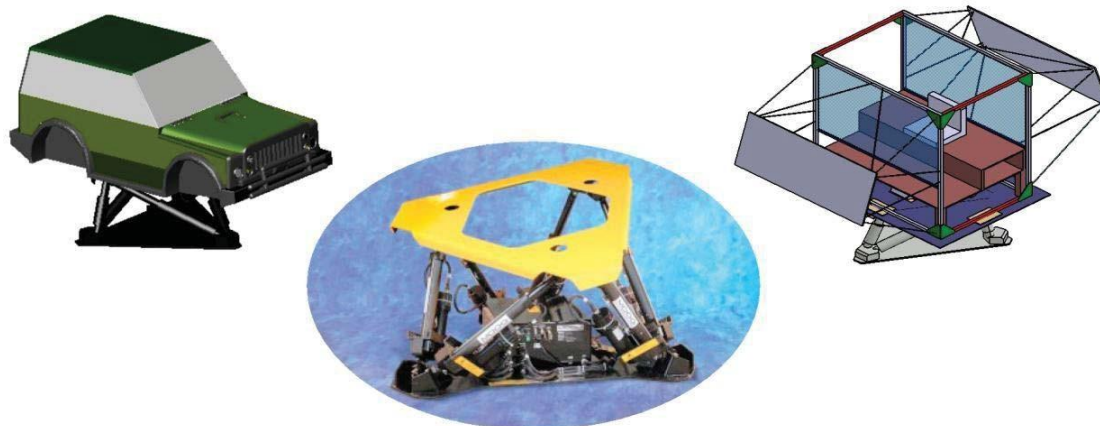
Platforma Stewart (centru) și vederi ale simulatorului virtual auto (în dezvoltare)
