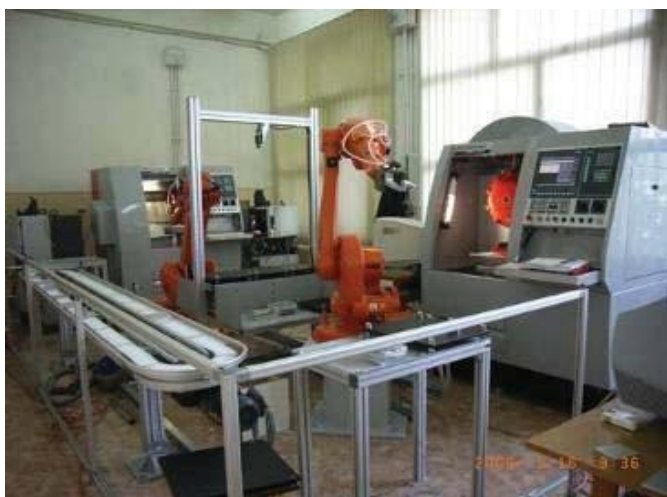
Celulă flexibilă cu 2 roboți ABB, 2 mașini CNC și prehensoare inteligente Barrett
