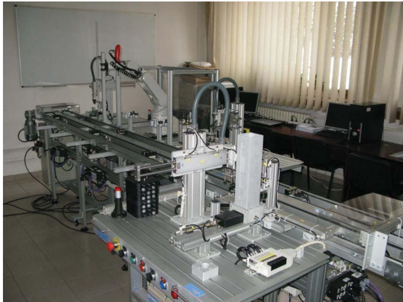
Celulă flexibilă de asamblare de tip SMC pentru instruire avansată
