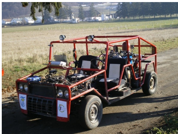
Figura 2.1.2 Concept-car cu propulsie hibrid-hidraulică și recuperare a energiei disipată în amortizoare, realizat în cadrul unei teze de doctorat
