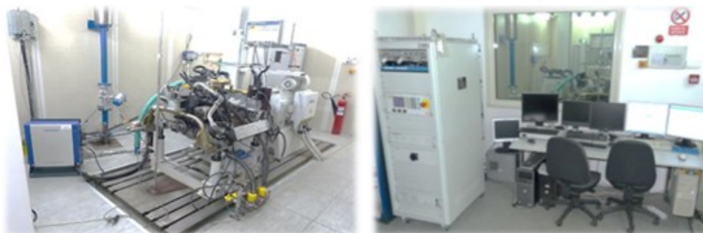
Stand Horiba Titan 250 pentru încercarea motoarelor policilindrice
