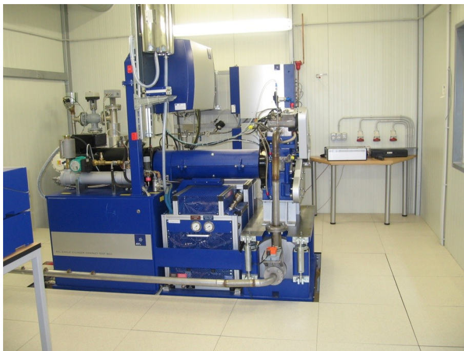
Figura 2.1.3 Standul Horiba din Laboratorul de Motoare al Catedrei
